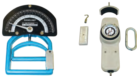
12-nji surat. El we aýak (stanowoý) dinamometrleri
