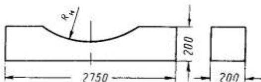
15-nji surat. Kiçi diametrli apparatlary transportirlemek üçin sosna agajyndan ýasalan ýassyk.
