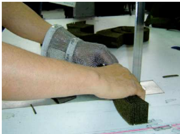
18-nji surat. Ekstrafor egin saklaýjy bilen matanyň kesilişi
