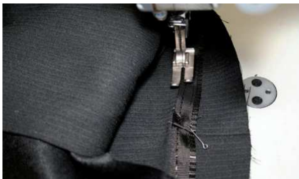
46-njy surat. Etek kesiklerinde jähegiň işlenilip bejerilişi
