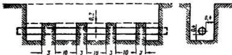
Surat 5.1. Nebitgazgeçirijini çukurda abatlamagyň tehnologiýa çyzgysy
