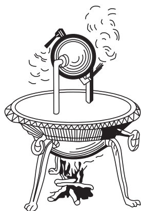
5-nji surat. Geronyň bug hereketlendirijisi (eolipili)
