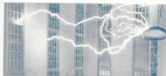
şar görnüşli zaryadsyzlandyryjyň diwar bilen aralygyndaky böwsülme hadysasy. Napryženiýasy 1600kV; Aralyk uzaklygy 16,5 m.
