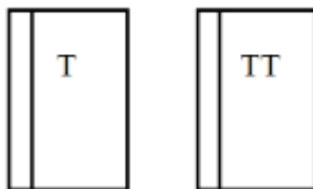
Shemalarda birbasgançakly triggerler bir sany T-harpy bilen, ikibasgançakly.
