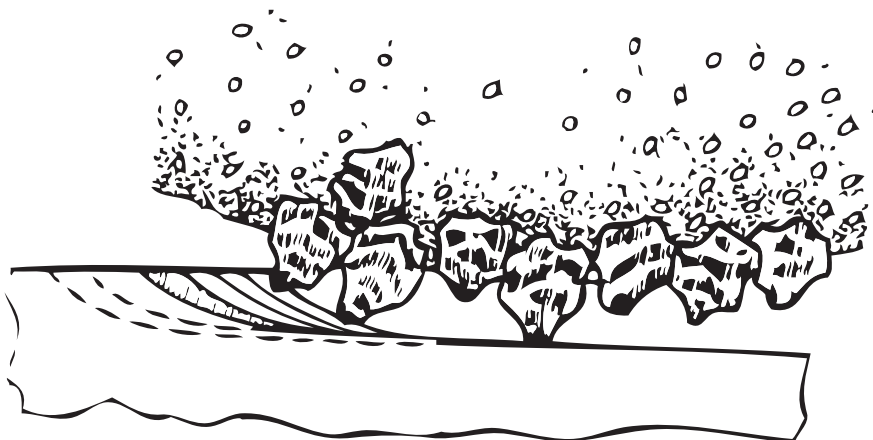
62-nji surat. Abraziw guralyň däneleriniň kesiji hereketiniň çyzygysy.
