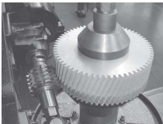
13.20-nji surat. Tigriň dişleriniň burumly freza bilen kesilişi
