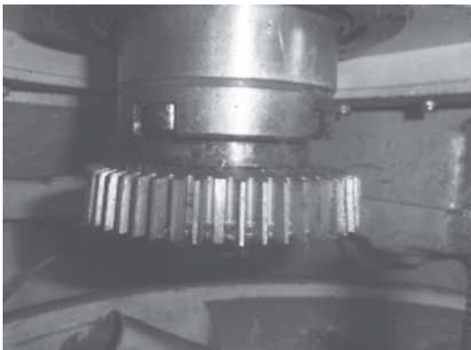
13.13-nji surat. Içki dişli tigrleriň urup kesiji gural bilen dişleriň ýasalýşy
