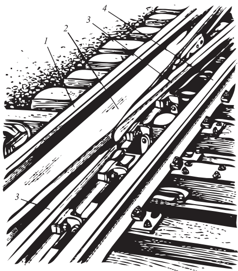
3.43-nji çyzgy. Süýşme serdeçnikli kütäk haç: 1-atanaklaýyn sowgutly geçirijiniň daşky relsi; 2-usowik; 3-serdeçnik; 4-atanaklaýyn sowgutly geçirijiniň içki relsi
