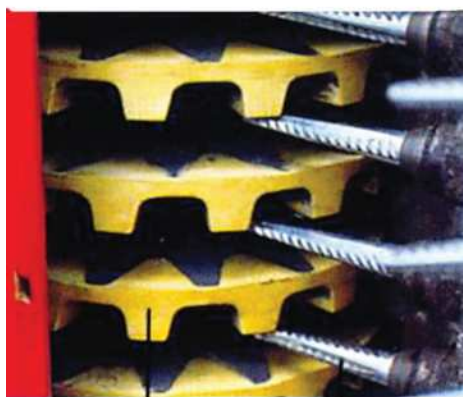
8.7-njy surat. Şpindel bilen dofferiň aragatnaşygy: 1 – doffer; 2 – şpindel
