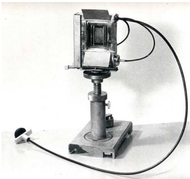
6.7-nji surat. Gün peçleriniň fokusynda şöhle energiýasyny registrirleýji gurluş.
