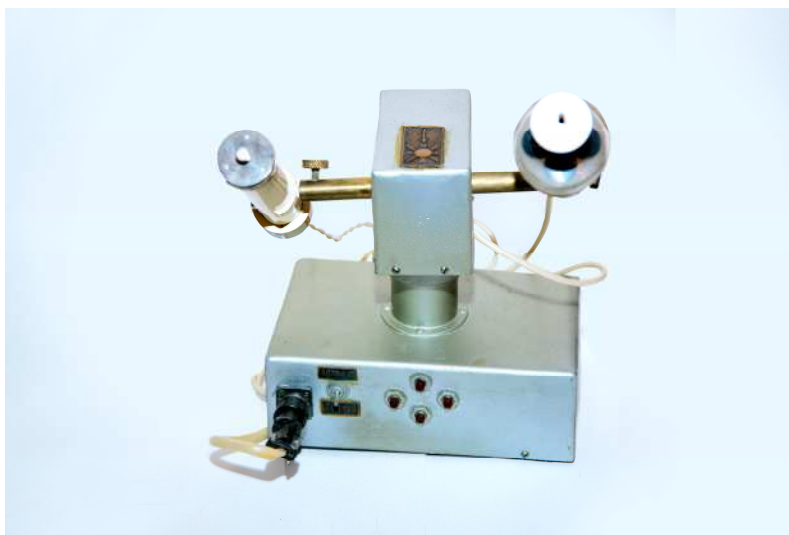
6.6-njy surat. Aktinometri Güne tarap gönükdiriji gurluş.
