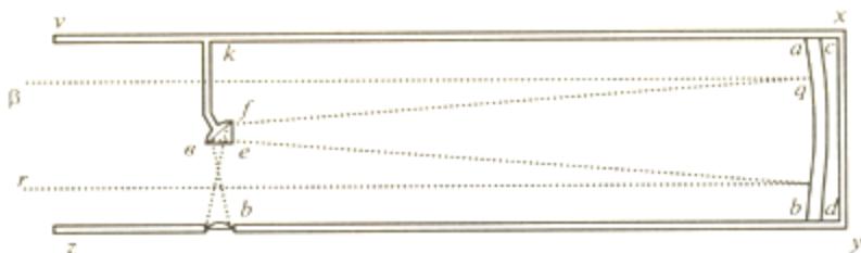
17-nji surat. Nýutonyň teleskopynyň çyzgysy
