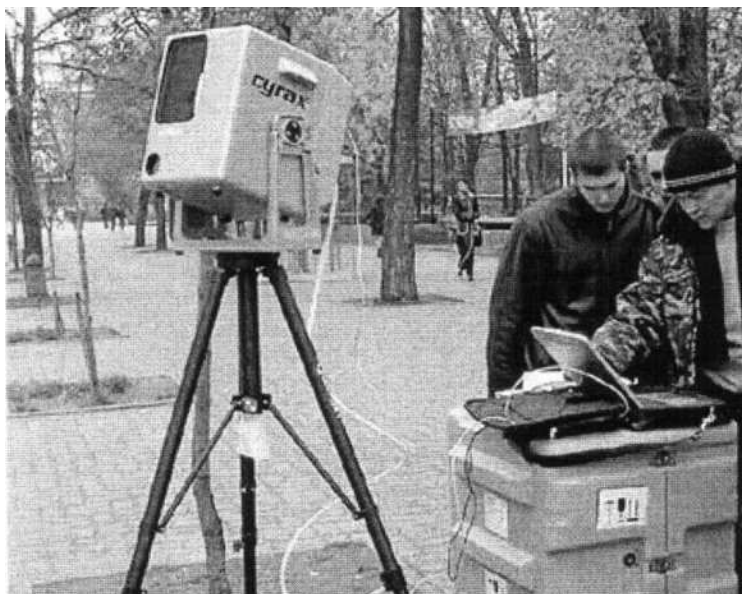
6.3.8-nji surat. Leica HDS2500 Lazer skaneri.
