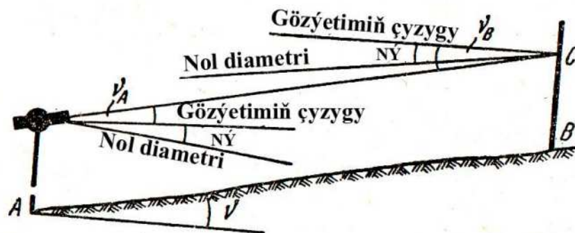
6.1.3 – nji surat. Ýapgytlyk burçunyň eklimetr bilen ölçenilişi.
