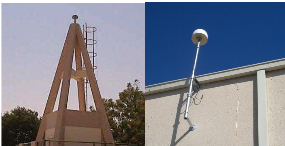
3.1.12-nji surat. Referens – stansiýalaryň berkidiliş usullary.
