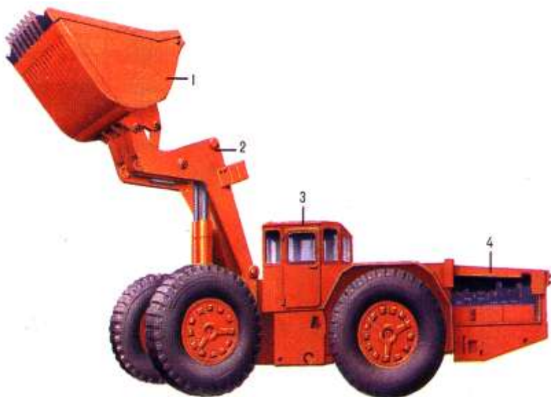
Surat-23. Ýerasty dag kánlerinde partladylan dag jynslaryny ýüklemek üçin ulanylýan birsusakly ýükleýji masynyň umumy görnüşi
