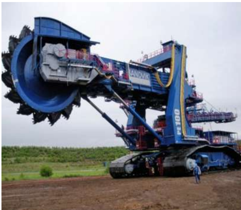
Surat-17. Rotorly ekskawatoryň umumy görnüşü
