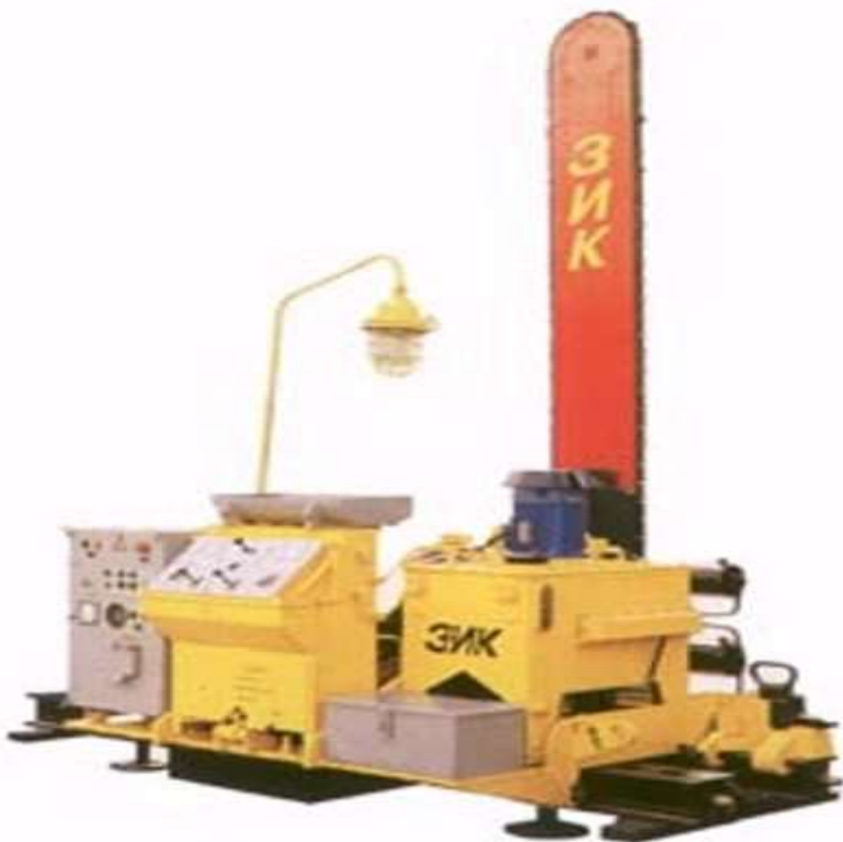
Surat-35. Zynjyrly daş kesýän maşynyň umumy görnüşi Granit we mermer bloklaryny almagyň tehnologiýasy we mehazimleşdirmek
