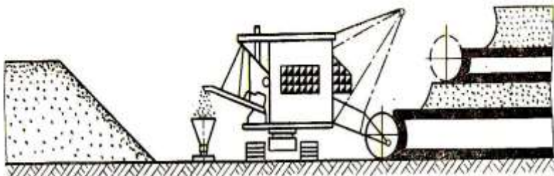
Surat-16. Rotorly ekskawatorlaryň iş shemasy.
