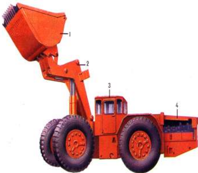
Surat-23. Ýerasty dag kánlerinde partladylan dag jynslaryny ýüklemek üçin ulanylýan birsusakly ýükleýji maşynyň umumy görnüşi
