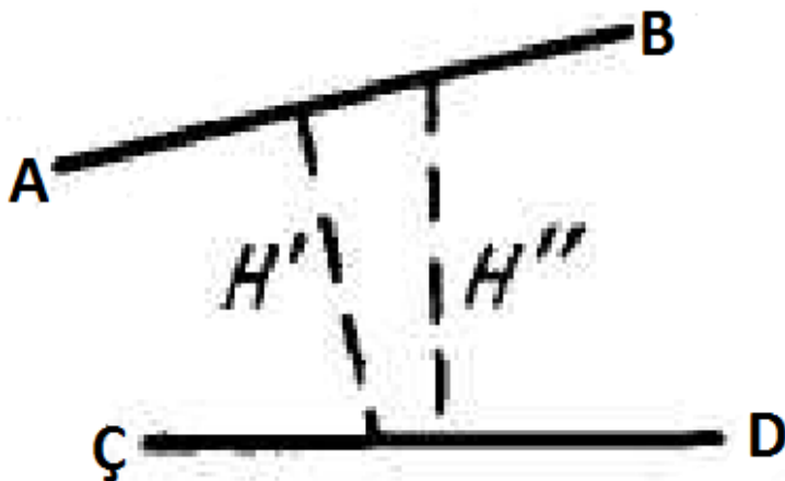
22-nji surat. Parallel däl kesimleriň arasynda ortaça uzynlygy kesgitlemegiň shemasy
