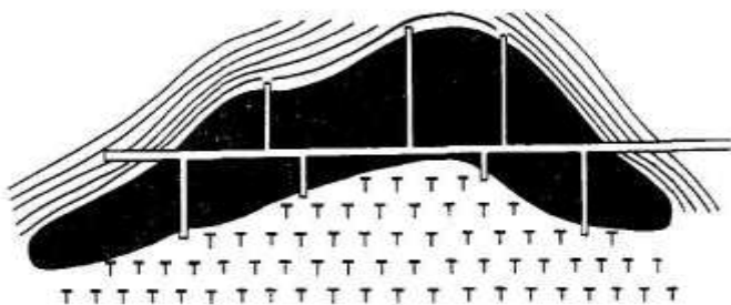
3-nji surat. Ýapgyt magdan gatlagyny kesmek üçin kese işletmesinden geçilen ýokara galýanlar we gezenkler
