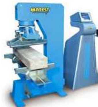
3-nji surat. Испытательная машина C091-03 markaly 150 kN epijiligi bolan barlag enjamy (Italyýa).
