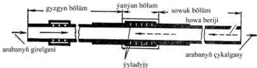
11-nji surat. Kerpiji bişirmek üçin tunnel görnüšli peç (boýuna kese-kesigi).
