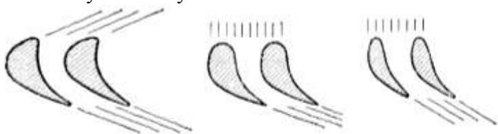
24.5-nji surat Turbina pilçeleriniň profilleriniň görnüşi
