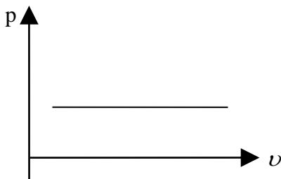
3.5-nji surat. Izobarik prosesiniň p - v diagrammasy
