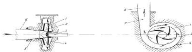
1.4-nji surat. Merkezden daşlaşdyry nasosyň şekilli: 1-işçi tigr; 2-perrikler; 3-wal; 4-korpus; 5-sorujy patrubka; 6-sorujy suwuklykgeçiriji; 7-çykaryjy patrubka; 8-naporly suwuklykgeçiriji.
